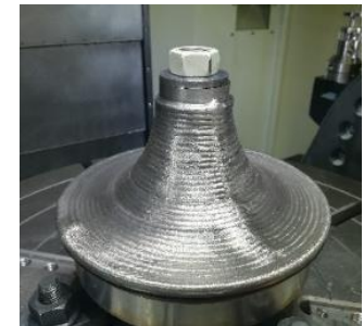
Navařená základová vrstva na soustružený polotovár
