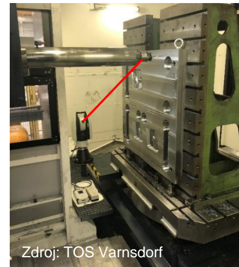
Přídavné odměřování laser trackerem
