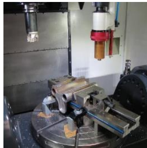
Pracovní prostor s hořákem i frézou
