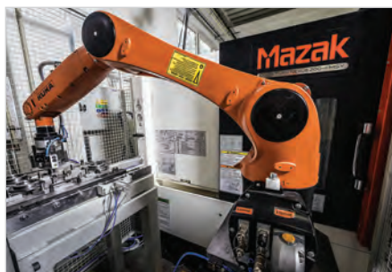
CNC obráběcí centrum Mazak Quick Turn Nexus 200-II MSY s robotem Kuka
