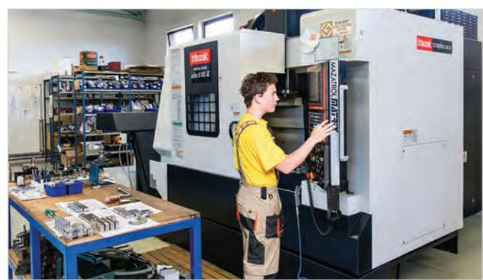
CNC obráběcí centrum Mazak Vertical Center Nexus 510C-II
