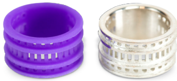
Voskový výtisk (fialový), zbvavený podpor a následně odlitý v požadovaném kovu (stříbrný) ve vysoké přesnosti a detailu.
